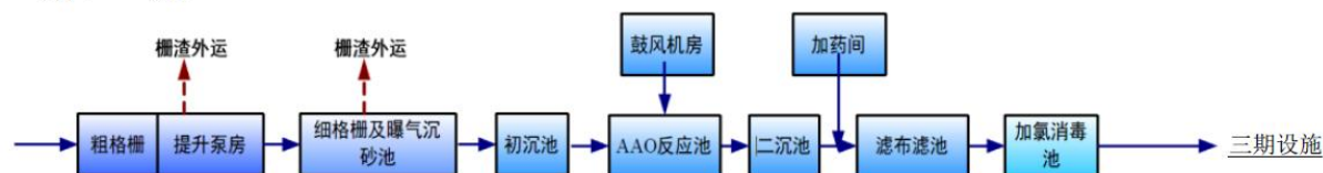
图 4-3 项目现状污水处理工艺流程图
