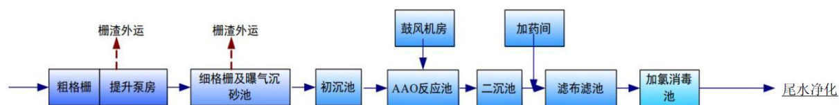
图 4-3 项目现状污水处理工艺流程图
