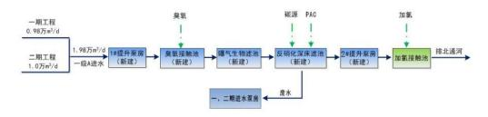
图 4-4 上马污水处理厂准IV提标工程工艺流程图
