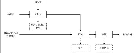
图 2-2 项目新风系统产品生产工艺及排污节点图工艺简述:
