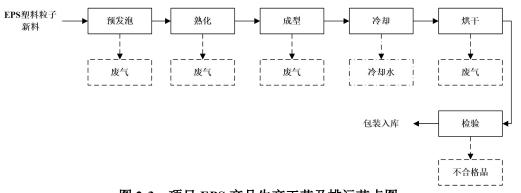
图 2-3 项目 EPS 产品生产工艺及排污节点图
