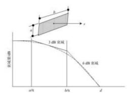
图 4-5 长方形面声源中心轴线上衰减特性
