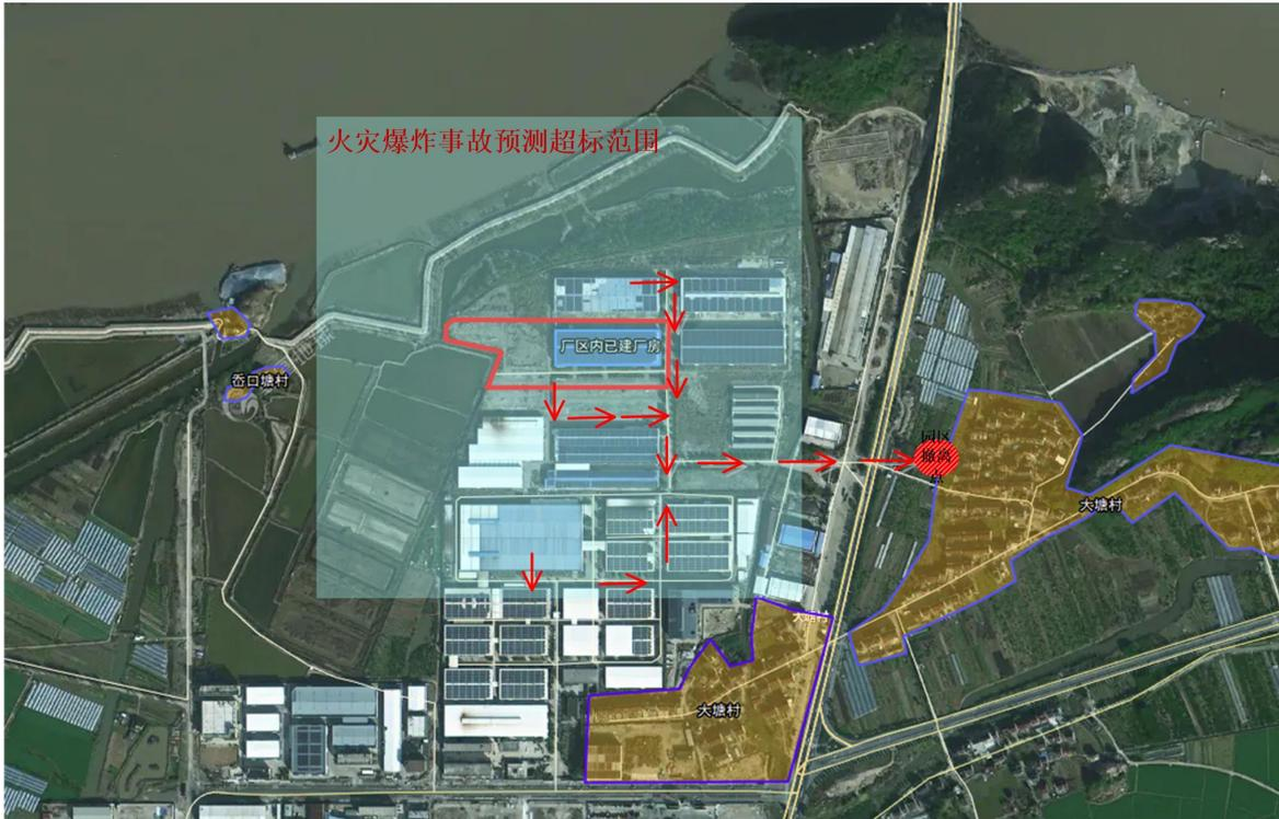
图 A.5-2 火灾爆炸事故工业区疏散路线图
