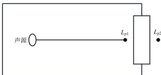
图 4-6 室内声源模型图
